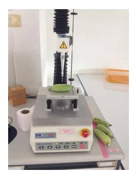
13. กด Start Test เครื่องจะทำการวัดตัวอย่างให้อัตโนมัติ
